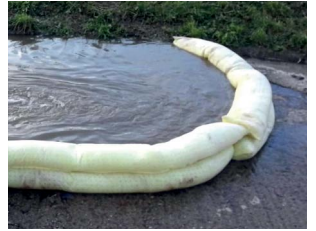
Abbildung 57: Einfach aber wirkungsvoll. Sperre mittels Wasserschutzschlauch.
